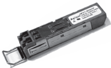
图2-14 千兆 SFP 光模块外观示意图
